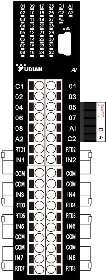
D92 尺寸本身无显示器及键盘，可通过 RS485 通讯接口与上位机计算机或触摸屏连接来完成其显示界面的功能及操作。也可以利用外接的 E85 型键盘及显示器进行显示及参数设置。
